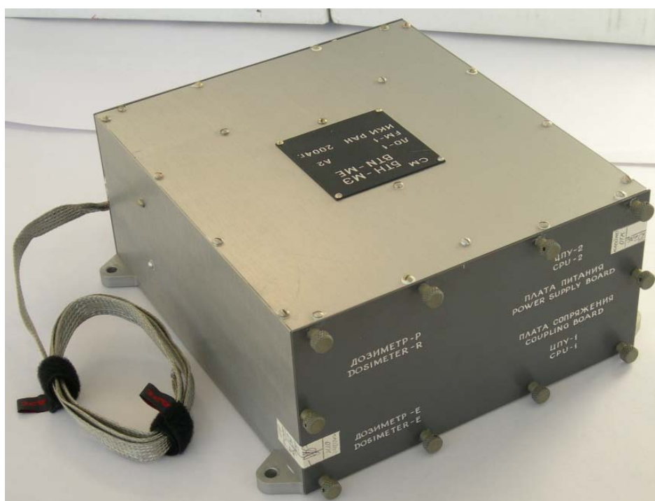
Рис.7.4. Блок электроники БТН-МЭ предназначен для установки внутри гермоотсека модуля «Звезда»
