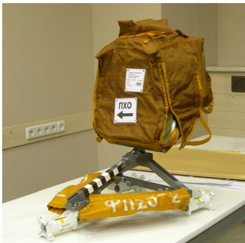
Рис.7.3. Детекторный блок БТН-МД предназначен для установки вне гермоотсека на внешней поверхности модуля «Звезда»
