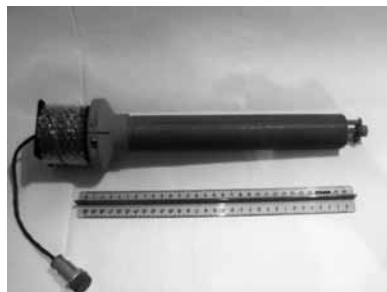
Рис. 2. Прототип датчика ДВМП-И — датчик ДВМП прибора ММФФ (проект СПЕКТР-Р)
