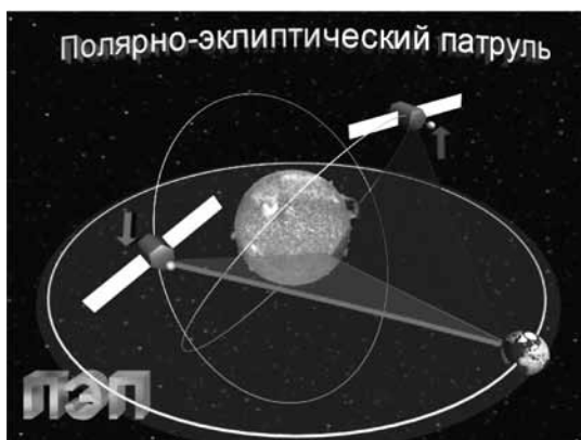
Рис. 2. Баллистическая схема миссии ПОЛЯРНО-ЭКЛИПТИЧЕСКИЙ ПАТРУЛЬ — расширенный вариант миссии ИНТЕРГЕЛИОЗОНД
