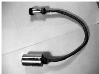
Рис. 1. Прототип датчика ДНМП-И — датчик ДНМП прибора ММФФ (проект СПЕКТР-Р)
