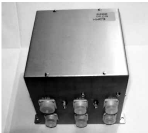
Рис. 6. Прототип блока электроники БЭ ИМВЭ — блок БЭ ММФФ (проект СПЕКТР-Р)
