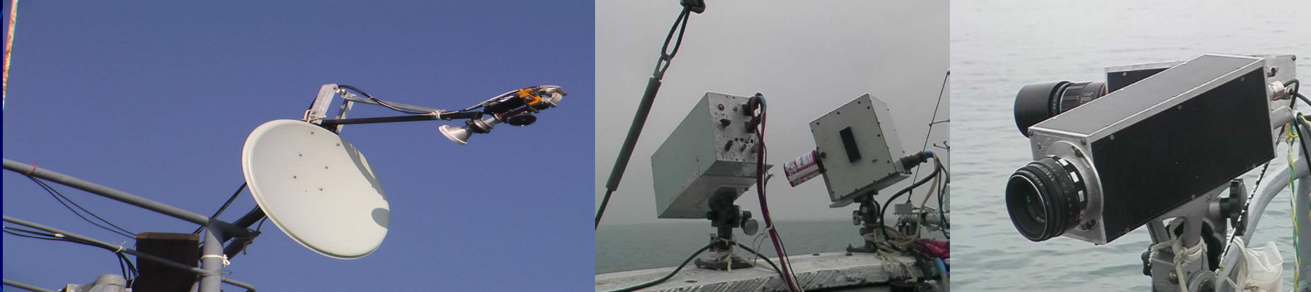
Доплеровские радары X и Ka диапазона, двумерный оптический спектроанализатор и линейка фотоприемников
